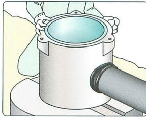
①管取付壁を押しながら、本管を可とう継手（スペーサージョイントキラスト）に挿入してください。
