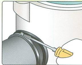
②可とう継手と本管とのすきまがないことを確認後、ステンレスバンドを十分に締め込みます。
