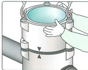
②直壁・斜壁を緊結用ボルトに通るようにして設置します。この時、ガイド目印(▲▼)が上下合うようにして下さい。
