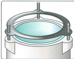
①管取付壁の上面を清掃し、緊結用腕部に緊結用ボルトを取り付けて、ゴムパッキンをセットします。
