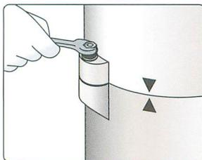
③締付けナットを締め込みます。この時、ゴムワッシャーのゴム部がワッシャー部と同じ径にふくらむまで締め込みます。
