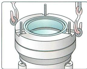
①斜壁に調整ボルトを取り付けて、調整リングをセットします。
